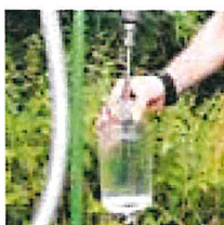
Entnahme von Grundwasserproben
