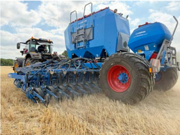
Die Solitär NT von Lemken kann mit bis zu 340 kg Scharndruck selbst härteste Böden knacken. Die Tankoptionen sind vielfältig – hier mit einem 5100-l-Doppeltank.
