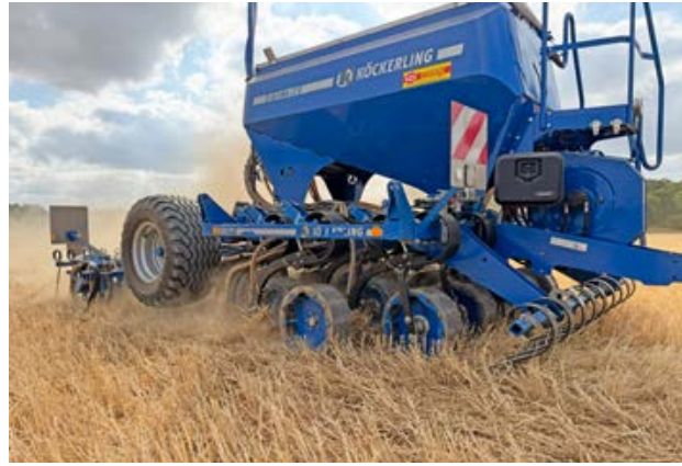
Die Kockerling Ultima CS eignet sich auch für den Einstieg in die Direktsaat. Die vorlaufende Tastrolle soll für eine gute Bodenangepassung des Scharns sorgen und eine hohe Ablagequalität gewährleisten.
