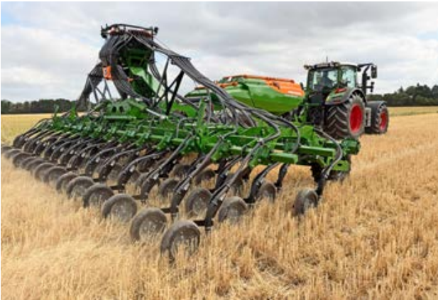
Die Amazone Condor mit 9 m Arbeitsbreite ist eine Zinken-sämaschine und wurde problemlos von einem 200-PS-Schlepper gezogen.
