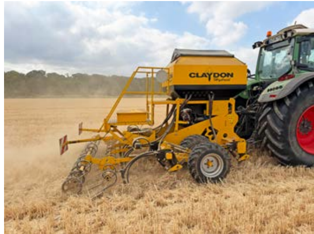
Vorlaufender Lockerungszinken und anschließende Aussaat mit einem Gänsefußschar – das Funktionsprinzip der Strip-Till-Sämaschine Evolution M3 von Claydon.
