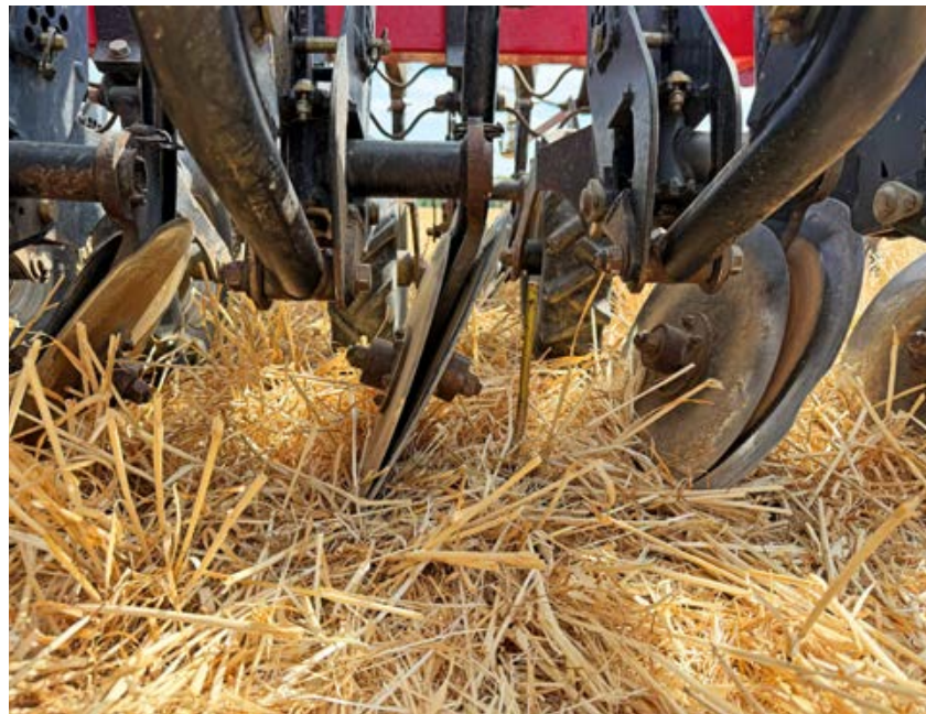
Die Scheibensämaschine Weaving GD6000T wurde speziell für die Direktsaat entwickelt. Ihre Besonderheit ist die starke Seitenneigung des Scharns.
